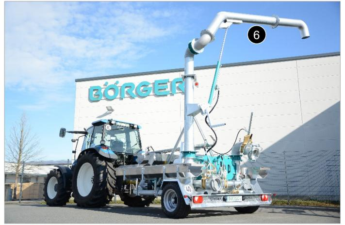
**加注臂[6]**由拖拉机的液压系统驱动，可伸缩和旋转。根据要求，我们提供一个额外的无线电遥控器。
