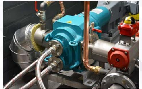
BLUeline旋转凸轮泵可配置加热衬套或加热泵盖
