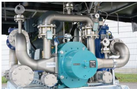
博格旋转凸轮泵和安全泵盖均满足ATEX防爆要求
